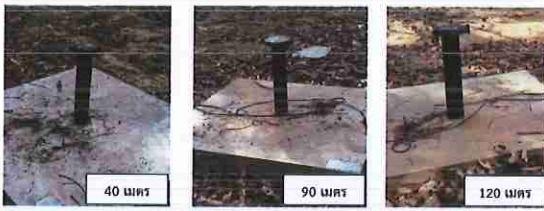
รูปที่ 4.16 การตรวจวัดระดับน้ำและเก็บตัวอย่างน้ำใต้ดินที่ ST04 ระดับความลึก 40, 90 และ 120 เมตร
