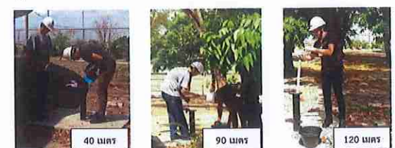
รูปที่ 4.15 การตรวจวัดระดับน้ำและเก็บตัวอย่างน้ำใต้ดินบ่อน้ำ ST03 ระดับความลึก 40, 90 และ 120 เมตร
