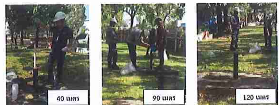
รูปที่ 4.13 การตรวจวัดระดับน้ำและเก็บตัวอย่างน้ำใต้ดินบ่อน้ำ ST01 ระดับความลึก 40, 90 และ 120 เมตร
