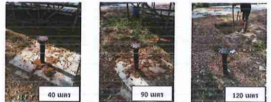
รูปที่ 4.17 การตรวจวัดระดับน้ำและเก็บตัวอย่างน้ำใต้ดินที่ ST05 ระดับความลึก 40, 90 และ 120 เมตร
