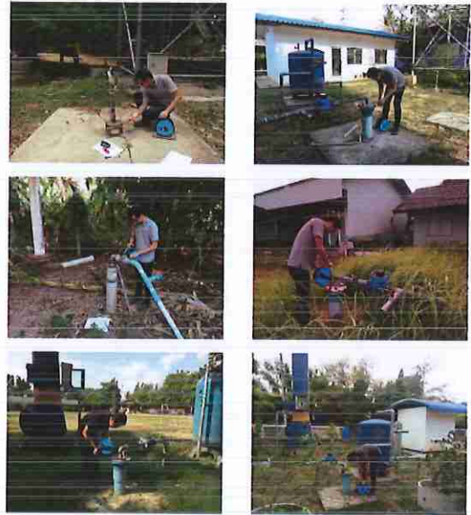
รูปที่ 4.7 การเก็บข้อมูลระดับน้ำใต้ดินภาคสนาม ระหว่างวันที่ 3-6 พฤษภาคม 2562 (ฤดูแล้ง)
